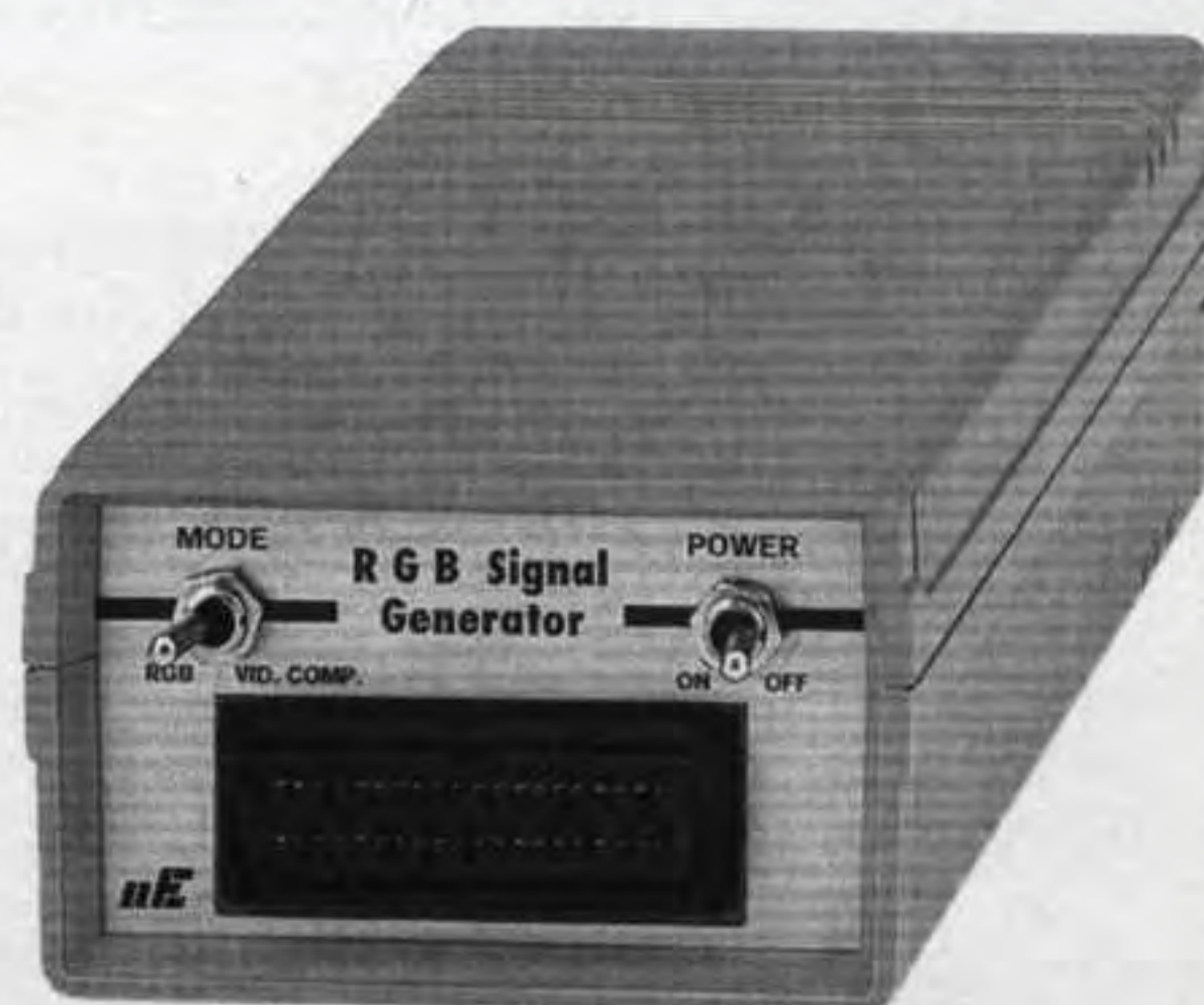
Fig.2 Tutto il circuito andrà racchiuso in un mobile plastico completo di un piccolo vano atto a contenere una pila da 9 volt.
