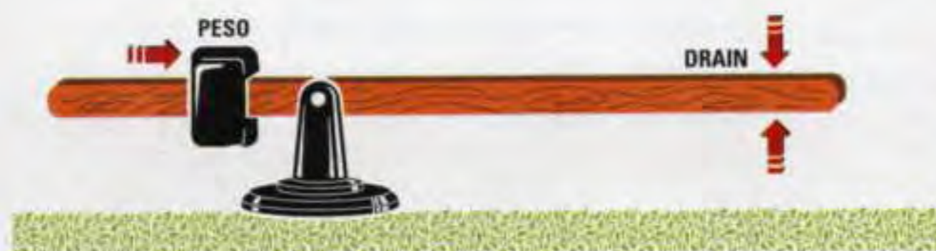
Fig.481 Per portare la leva in posizione orizzontale occorre spostare il peso di Gate più verso il suo fulcro e questo spostamento si ottiene applicando sul terminale Gate una tensione "negativa".
