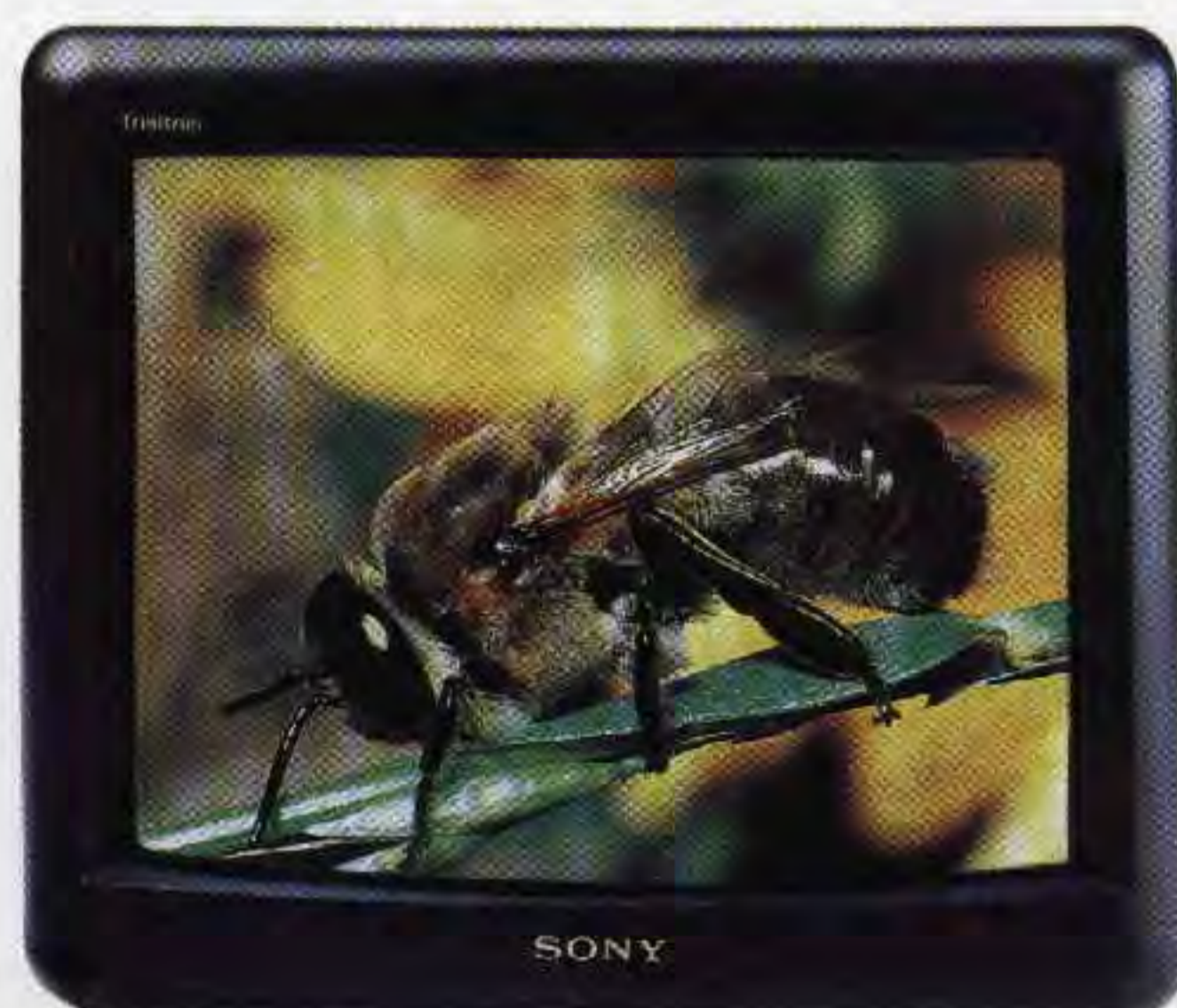
Fig.6 L'obiettivo inserito in questa microtelecamera funziona anche da ottima lente d'ingrandimento. Per ottenere questa foto ci siamo avvicinati ad un'ape e siamo riusciti ad ingrandire il suo corpo, lungo pochi centimetri, di circa 20 volte in modo da coprire tutto lo schermo TV.
