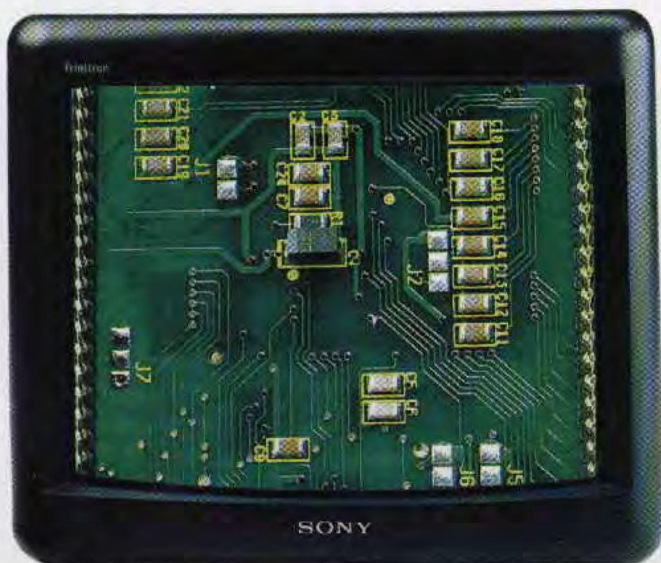
Fig.7 Posto un minuscolo montaggio in SMD a pochi centimetri dall'obiettivo è possibile vedere questo circuito notevolmente ingrandito. In pratica, e' come avessimo a disposizione un piccolo microscopio che ci permette di vedere se esistono delle saldature imperfette.
